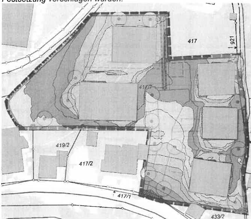
Abb: Straßenverkehrsgeräusche, nachts, 1. OG, ab gelb sind Schutzmaßnahmen erforderlich
